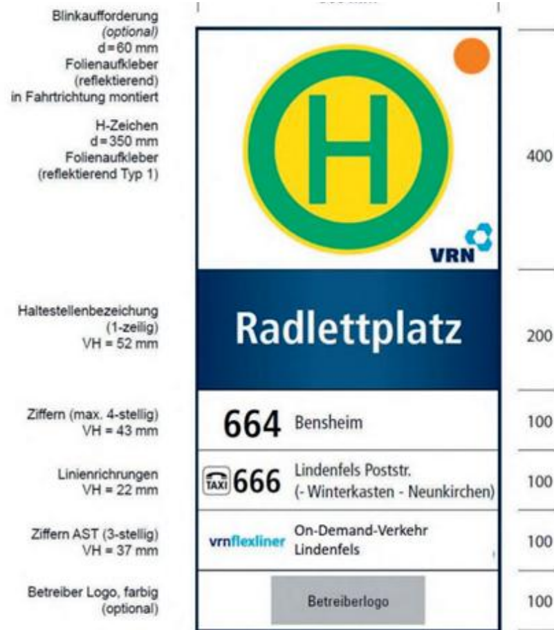
Abbildung 32: Wechselschildsystem mit gewölbter Oberfläche (höherwertige Systeme) – rechts als Stele
